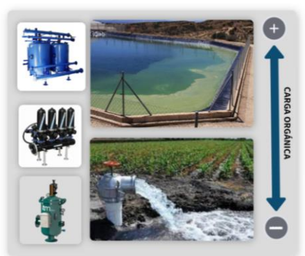
Ilustración 2. Selección de tipo de filtrado en función de la carga de partículas orgánicas presentes en el agua de riego.
